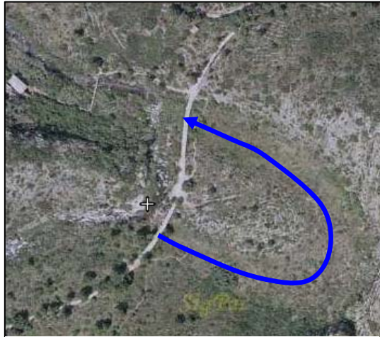
Foto 2: Meandro descolgado por presencia de infraestructura
